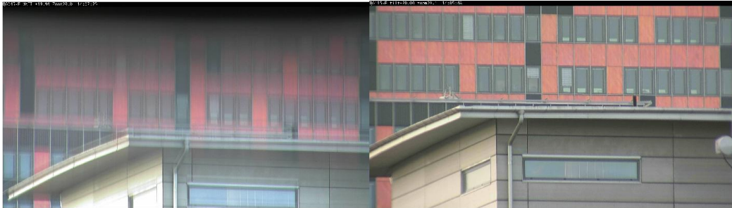
Slika 6: konvencionalna kupole (levo) i Sharpdome (desno) sa 20° nagiba i 20x zumom.
