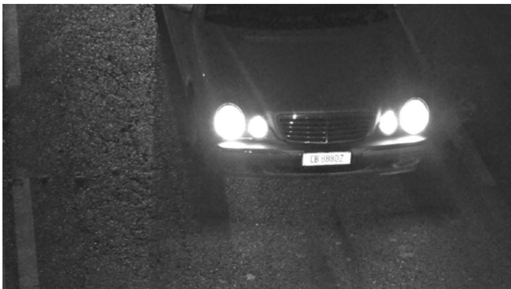
Slika 2: korišćenje IC osvetljenja za prepoznavanje registarskih tablica (LPR)
