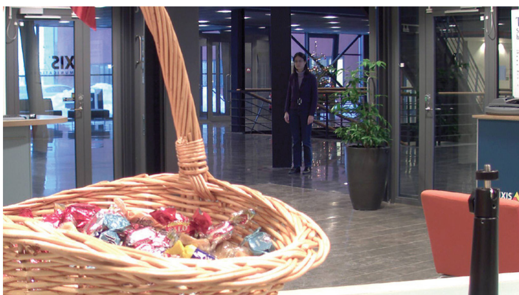
Sl. 4. Obratite pažnju na veliku dubinu polja u slici preuzete sa kamere sa P-Iris objektivom
