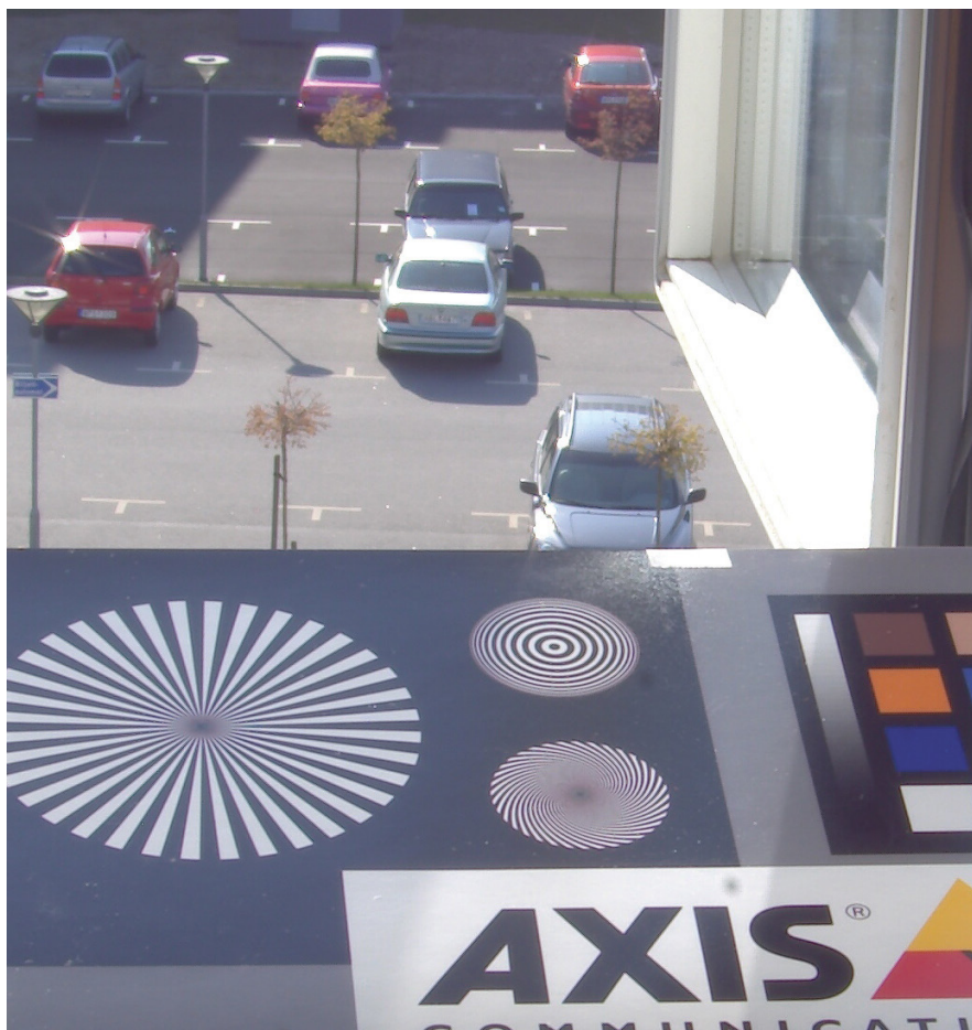
Sl. 5. Obratite pažnju na oštar kontrast na slici sa kamere sa P-Iris objektivom
