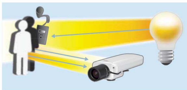
Slika 1. Razlika između svetlosti merene lux-metrom i reflektovane svetlosti koju hvata kamera.
