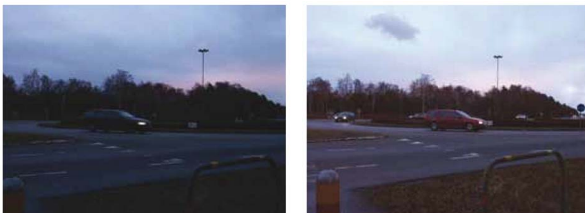
Slika 3. Sa leve strane, scena od 500 luksa sa malim pojačanjem. Sa desne strane ista scena od takođe 500 luksa, ali sa velikim pojačanjem. Primeri pokazuju kako se pojačavanjem video signala povećava osvetljenost slike, ali i nepoželjnog šuma.
